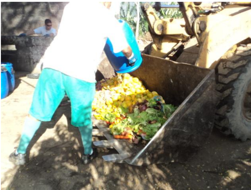
Foto 02 - Trabalhador descarregando bombonas com orgânicos para depositar nas leiras de compostagem.
