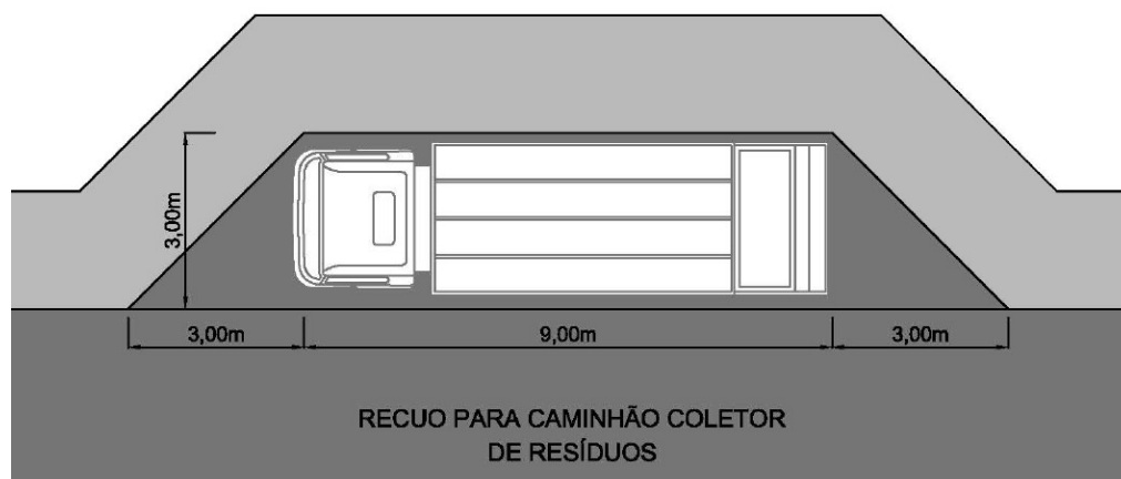
Figura 1 - Características e dimensões mínimas do recuo para o caminhão coletor .
